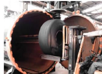
La vulcanización mencionada dependiendo de cada caso y cada tipo de industria, se consigue mediante vapor directo en unos casos y aire caliente en otros, aunque en OLMAR, ya hemos fabricado autoclaves que pueden trabajar con ambos sistemas.
